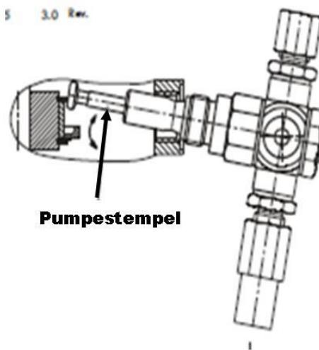
**Stopp pumpen med "slikkepotten" i tanken på motsatt side for pumpelementet.**
